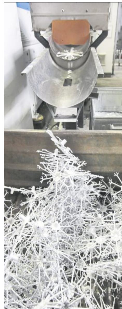
Bisher angefallener Anguss-Abfall beim Druckguss. Archivbilder: Schneider
