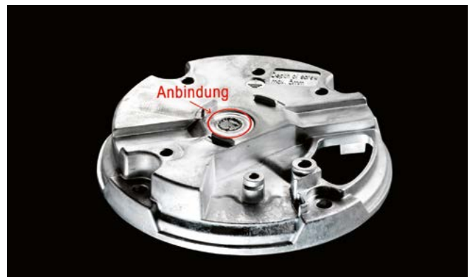
Bild 7: Mit Heißkanaltechnologie hergestellte Motorenabdeckungen für Ventilatoren Quelle: Föhl
