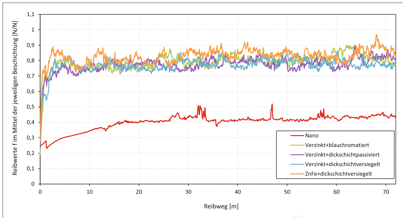
Bild 3: Tribologische Untersuchungen weisen für „Föhlan“-beschichtete Gestellware ein stabiles Reibniveau von 0,4 bis 0,45 aus.
